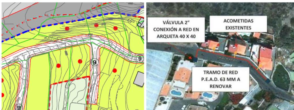
Se ha llevado a cabo la renovación del tramo de tubería de 70,70 metros lineales, empleando tubería de polietileno PE100 PN16 de 63 mm de diámetro. El trazado se realiza a través de un pase en la vía y por el margen derecho de subida de la calzada, llevando a cabo la conexión hidráulica a la red existente de Polietileno en ambos extremos.
