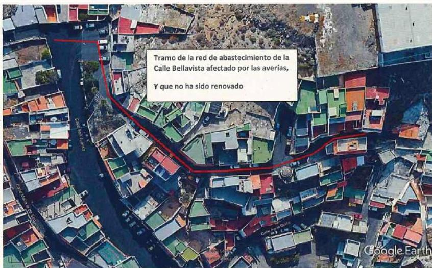
Para la renovación de este tramo se propone sustituir la red existente por una nueva con conexión al inicio de la red de refuerzo de la Calle San Juanito de material PEAD DN-90 mm, esto es, 189 metros de conducción de polietileno de alta densidad de 63 mm y 93 metros de conducción de polietileno de alta densidad de 32 mm.
