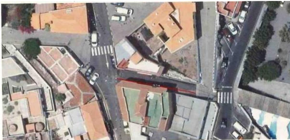
Se ha llevado a cabo la renovación del tramo de tubería de 25 metros lineales, empleando tubería de polietileno PE100 PN16 de 63 mm de diámetro. El trazado se realiza a través de la referida calle por el margen derecho de bajada de la misma.
