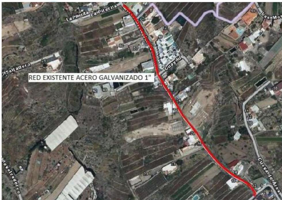
Para la renovación de este tramo de la red de abastecimiento de agua potable se propone la sustitución de la red existente con tubería PE PEAD DN 90mm PN 25 para la red principal con una longitud de 350 metros.
