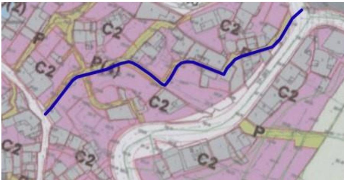
Se ha llevado a cabo la renovación del tramo de tubería de 45 metros lineales, empleando tubería de polietileno PE100 PN16 de 25 mm de diámetro. El trazado se realiza a través de la referida calle por el margen derecho de la misma.
