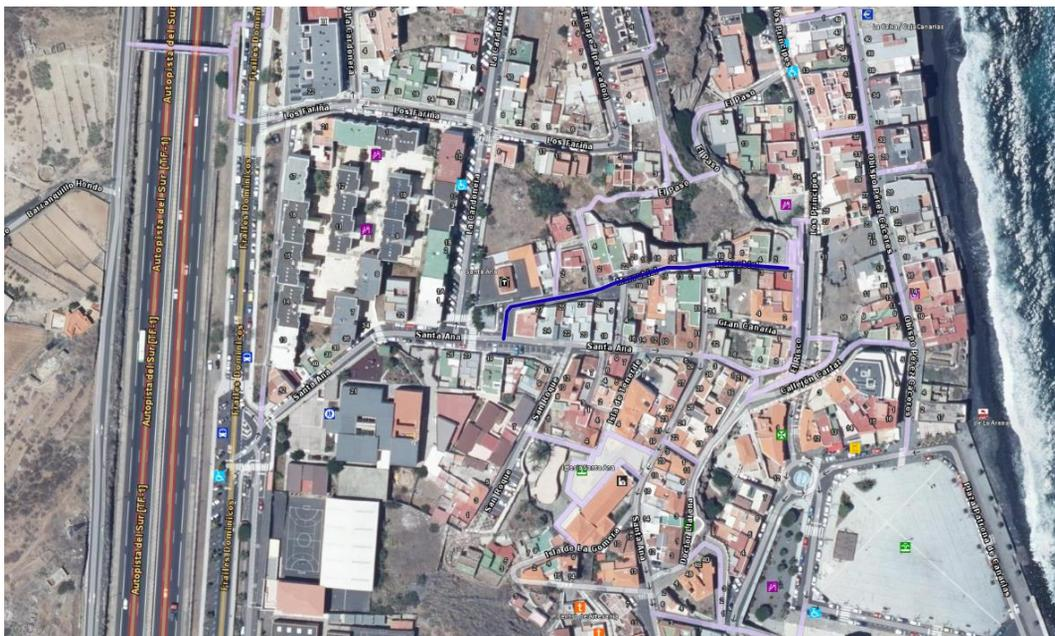
Se llevó a cabo la renovación de la red de abastecimiento de agua potable en PEAD diámetro 63 mm, en una longitud de 30 metros, así como la renovación del tramo de red de saneamiento en PVC-U, SN-4, DN=160 mm, en una longitud de 18 m.
