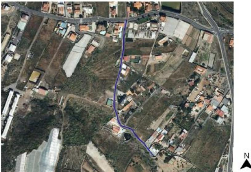
Renovación del tramo de tubería de **200 metros lineales**, empleando tubería de polietileno **PE100 AD, DN-63 mm y PN-25 atm**; con **2** conexiones hidráulicas a la red existente; realizando la instalación de conexiones de **9 acometidas a la Red Secundaria**, con tubería de polietileno **PEAD DN-25 mm** de diámetro y **PN-16 atmósfera y banda azul**.
