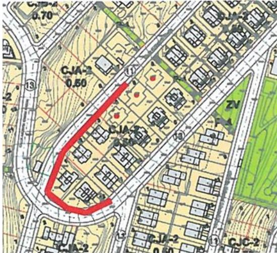
La renovación de este tramo de tramo de tubería de 107 metros lineales de polietileno PE100 PN16 de 75 mm se realizará por el mismo tipo de tubería. El trazado se ha realizado por la calzada pegada al bordillo de acera, así como la renovación de las 6 acometidas domiciliarias DN25 mm existentes, dos conexiones a la red de abastecimiento existente con sus respectivas llaves de corte alojadas en arqueta y un contador de velocidad para el control de las pérdidas en la red.
