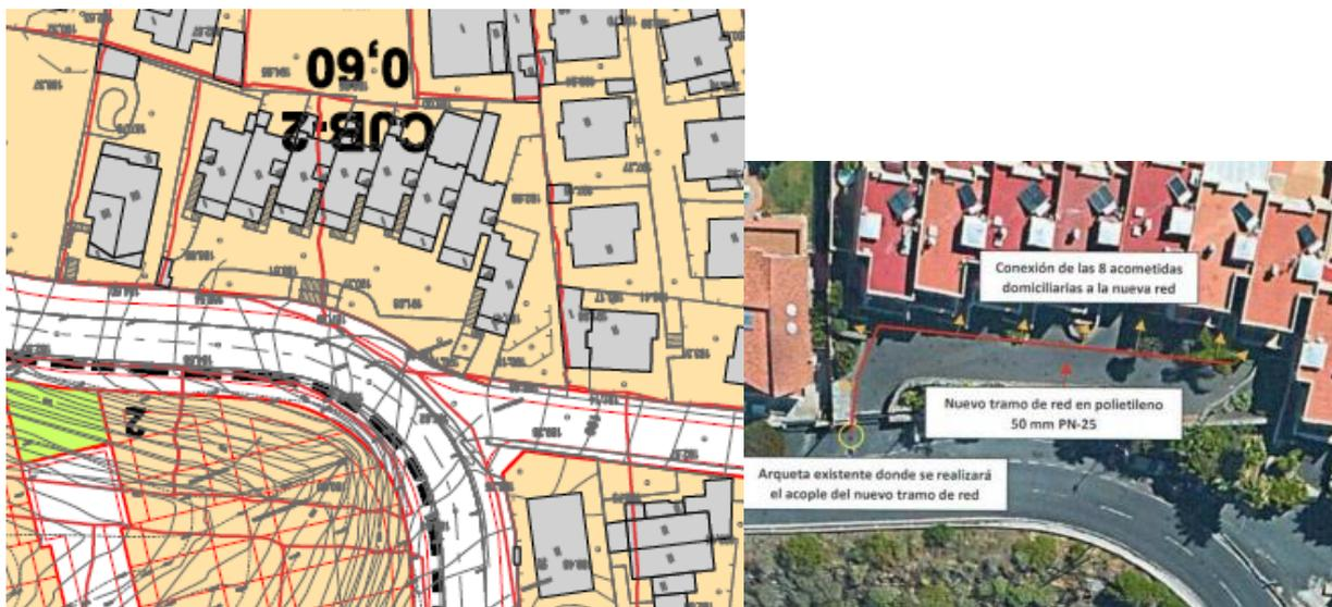
Se ha llevado a cabo la renovación del tramo de tubería de 55 metros lineales, empleando tubería de polietileno PE100 PN16 de 63 mm de diámetro. El trazado se ha realizado en el frente de dicha Vía Cabildo 51.
